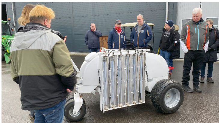
Mobil utrustning med UV-belysning för bekämpning av snömögel på golfbanor.
